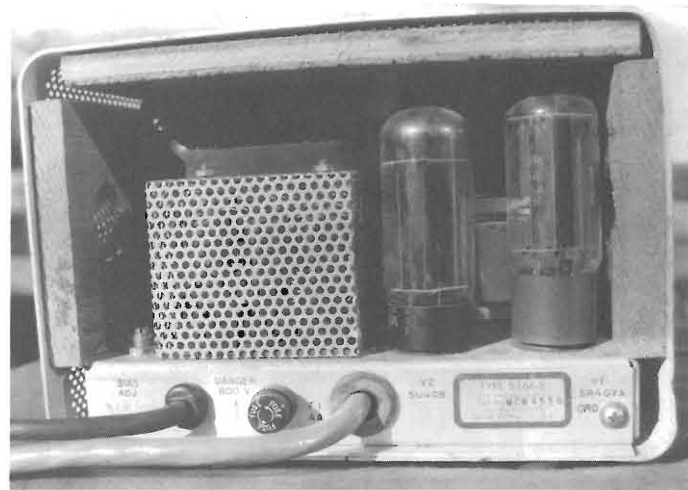
L'alimentatore 516 F2 visto da dietro, con le due belle... bottiglie 5R4 e 5U4.
