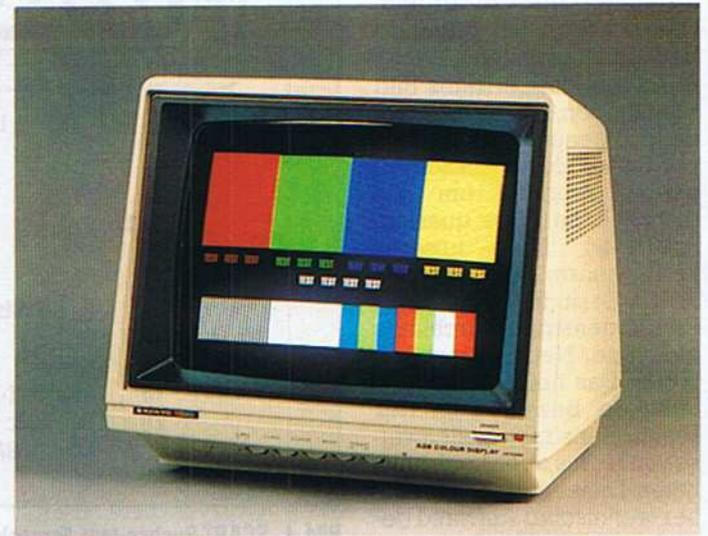
nitoren nur durch die direkte Verwendung des RGB-Signals erreichbar. Dafür wiederum sind Monitore notwendig, die sowohl über eine höhere Auflösung, als auch über einen entsprechenden Signaleingang verfügen als ihre nur für 40 Zeichen ausgelegten »Kollegen«. Ein solcher Monitor ist der CD 3220 N von Sanyo. Er ist für unter 900 Mark erhältlich, und kann nur an den
