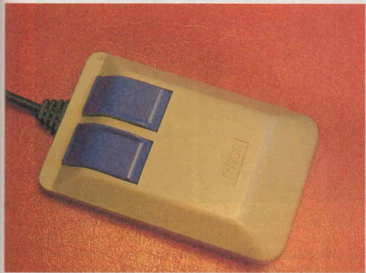
Die NCE-Maus besitzt einen eigenen 4-Bit-Prozessor.
