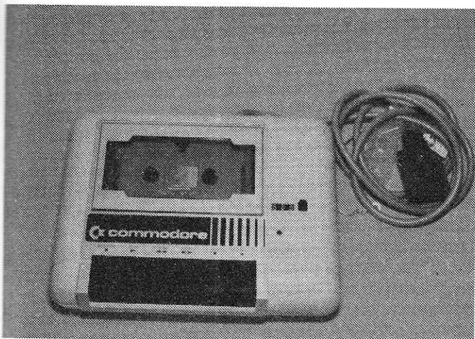
Commodore Datasette 1530 (VC-20/C-64). Außer der Farbe und dem Anschlußstecker mit der 1531 für den C16 identisch.
