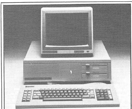
De nieuwe Commodore met standaard 256 Kb geheugen, inclusief toetsenbord, dubbel diskette station en inclusief een monochrome high-resolution monitor.
