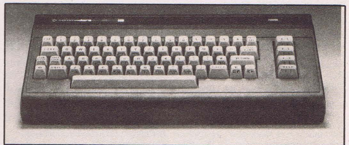
Bild 2. Die Tastatur ist bewährt und gut. Erkennbar ist die gegenüber dem VC20 geänderte Belegung einiger Tasten.
