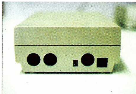
Die Rückseite mit seriellen Anschlüssen und Dip-Schaltern ähnelt der 1571
