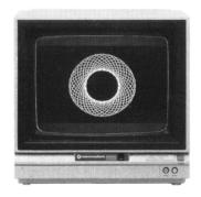
Der Bildschirm stellt eine der Schnittstellen des COMMODORE PLUS/4 zur Außenwelt dar. Jede Eingabe über die Tastatur, jede Meldung des Betriebssystems, jeder Ladevorgang usw. wird am Bildschirm angezeigt. Dabei besteht kein Unterschied zwischen einem S/W-Monitor (Schwarz/Weiß-Bildschirm) und einem Farbfernseher.
