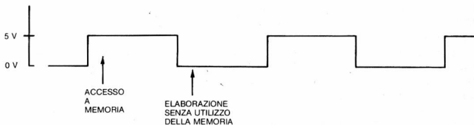
Figura 4.5 Segnale \phi 0 , il clock del sistema
