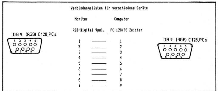
Bild 1: Anschluß eines RGB-Digital-Monitor mit neunpoliger Anschlußbuchse an den PC 128 im 80-Zeichen-Modus.
